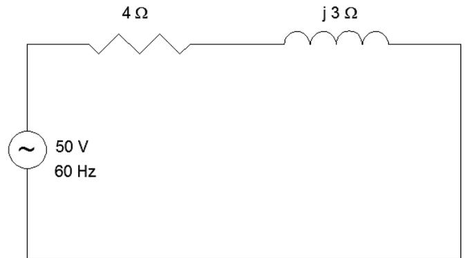
Nesse circuito, os valores do módulo da impedância, da corrente, da tensão no resistor e da tensão no indutor são, respectivamente:
